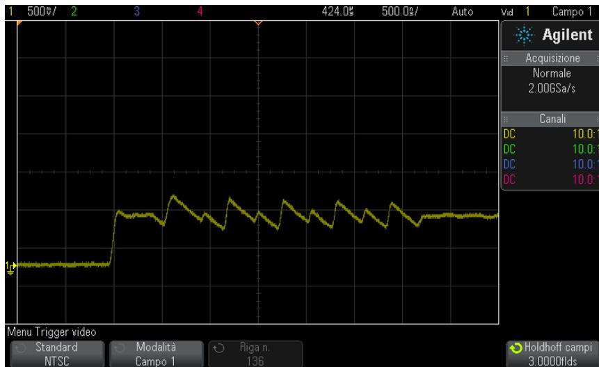
**Figura 32** Utilizzo dell'Holdoff campi per sincronizzare con il Campo colore 1 o 3 (modalità Campo 1)
