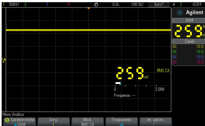
Il voltmetro digitale effettua misurazioni RMS precise quando la frequenza del segnale è compresa tra 20 Hz e 100 kHz. Se la frequenza del segnale non rientra in questo intervallo, "<Lim. BW?" o ">Lim. BW?" viene visualizzato nel display DVM per avvisare l'utente circa la presenza di risultati della misurazione RMS non accurati.
