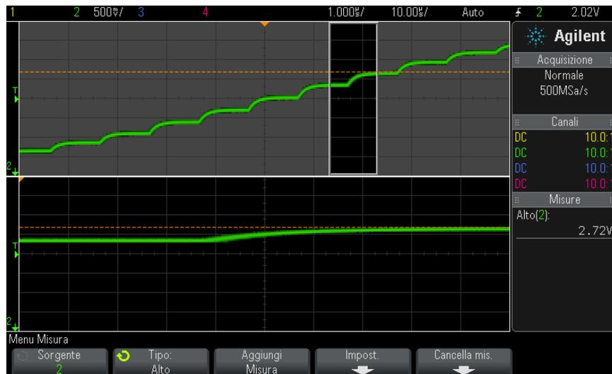
**Figura 45** Isolamento di un'area per la misura di Alto
