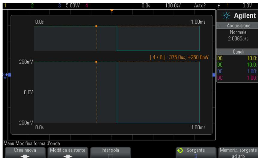
Quando si apre il menu Modifica forma d'onda, si vede la definizione della forma d'onda arbitraria esistente. La tensione e il periodo visualizzati nel diagramma sono i parametri vincolanti ricavati dalle impostazioni della frequenza e dell'ampiezza nel menu principale del generatore di forme d'onda.
