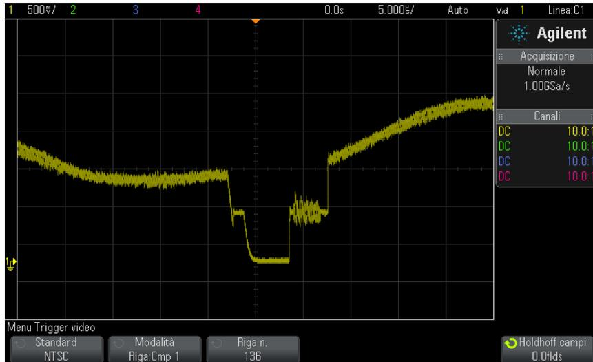
Figura 27 Esempio: Trigger sulla Riga 136
