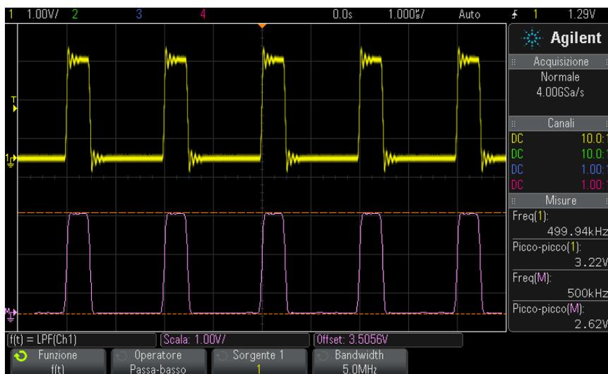
Figura 15 Esempio di filtro passa-basso
